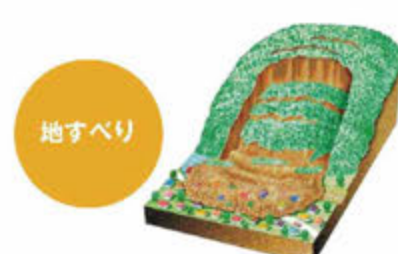
山や斜面の一部が、ある程度原形を保ったままゆっくりと下方に移動する現象です。降雨や融雪による地下水位の上昇、人為的な地形改変などによって起こります。
