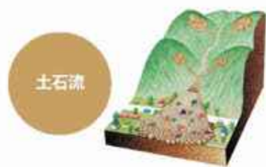
土石流 大雨などで山の斜面が崩れたり谷底にたまった土砂が流れ出したりしたときに水と土砂が混じりあってもすごい勢いで谷から流れ出す現象です。
