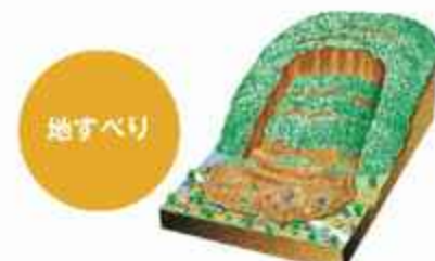
山や斜面の一部が、ある程度原形を保ったままゆっくりと下方に移動する現象です。降雨や融雪による地下水位の上昇、人為的な地形改変などによって起こります。
