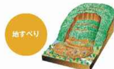
地すべり 山や斜面の一部が、ある程度原形を保ったままゆっくりと下方に移動する現象です。降雨や融雪による地下水位の上昇、人為的な地形改変などによって起こります。
