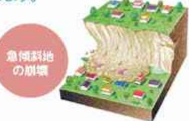
急な斜面（がけ）が突然崩れ落ちる現象です。大雨や地震が引き金になって起こります。
