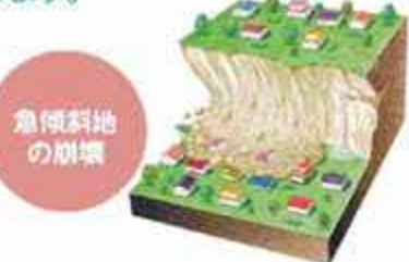
急傾斜地の崩壊 急な斜面（がけ）が突然崩れ落ちる現象です。大雨や地震が引き金になって起こります。
